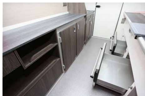
Drehtürunterschränke und umgebauter Radkasten
